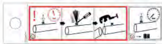
940 – Warnhinweis "Transportfüllung" am Schraderventil
